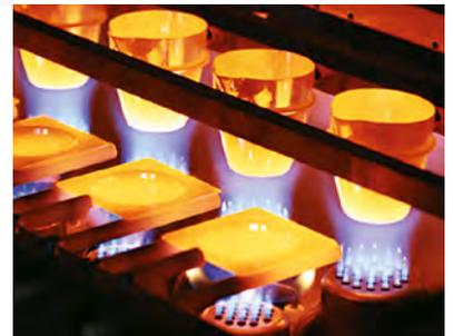
**Schmelzaufschluss für die Röntgenfluoreszenzanalyse.**
