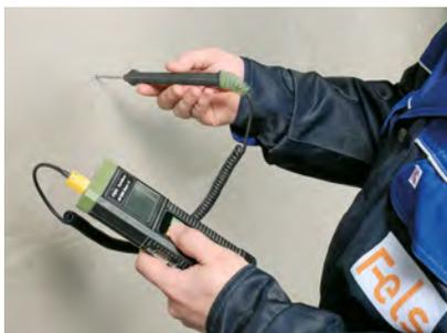
Temperaturmessung in der Porenbeton-Produktion.
