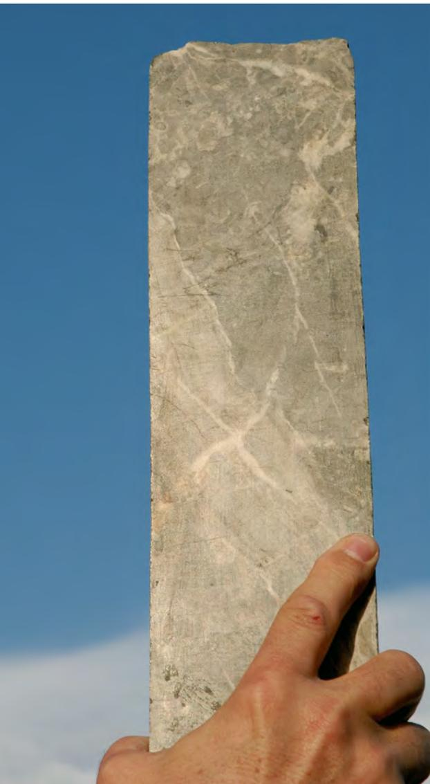
**Bohrkern aus einer Kernbohrung zur gezielten Abbausteuerung.**
