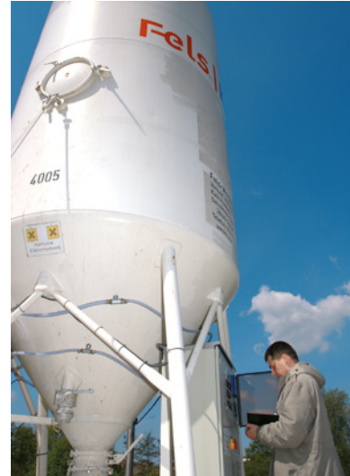
Betriebsversuch mit maßgeschneiderter Fels-Dosieranlage
